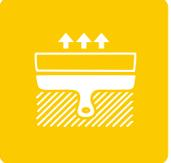
1. Штукатурка наносится на основание слоем от 5 до 25 мм при помощи специального инструмента (полутерка, кельмы, шпателя) набрасыванием или намазыванием, движениями «снизу-вверх», начиная с низа стены.
