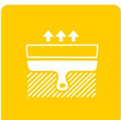
Штукатурка наносится на основание слоем от 5 до 30 мм при помощи специального инструмента (полутерка, кельмы, шпателя) набрасыванием или намазыванием, движениями «снизу-вверх», начиная с низа стены.
