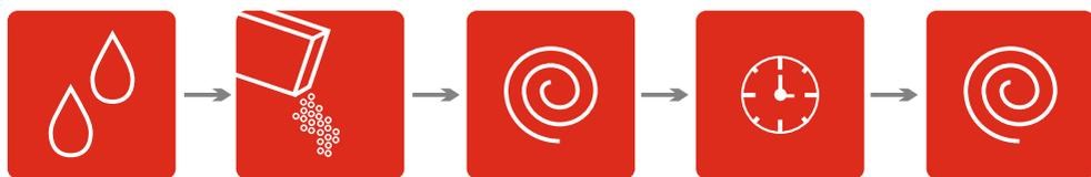
В емкость для приготовления раствора налить точно отмеренное количество холодной воды из расчета 0,45 – 0,50 л. на 1 кг смеси \ 11,25 – 12,5 л. на мешок смеси 25 кг.
